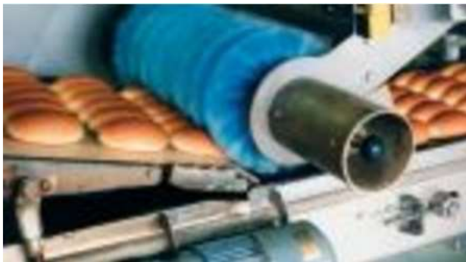
Рисунок 1 – Устройство для выгрузки из форм, действующее по принципу граблей
