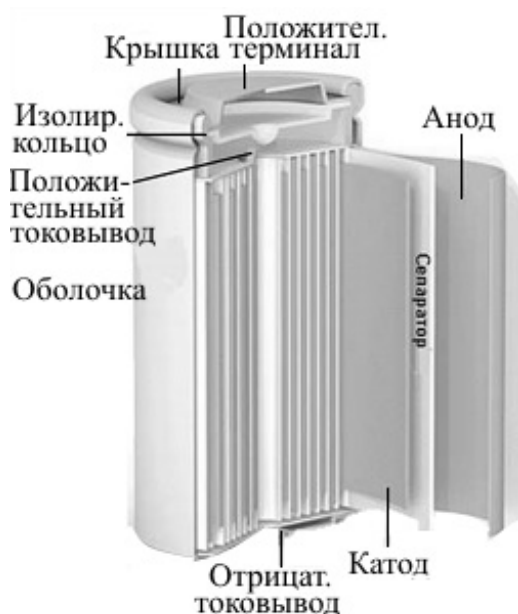
Рисунок 2 – Конструкция литий-ионного аккумулятора
