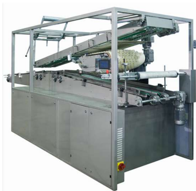
Рисунок 2 – Вакуумное устройство для выгрузки из форм
