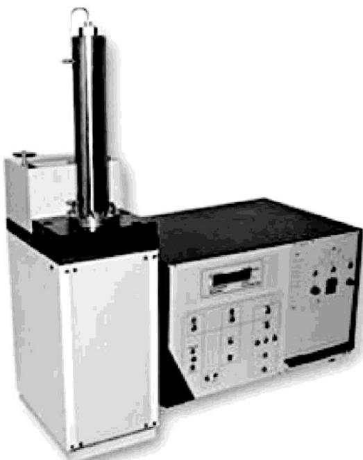
Рисунок 4.10 – Лабораторный сверхкритический флюидный экстрактор (СФЭ -400)
