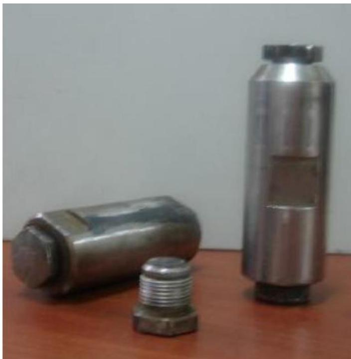
Рисунок 5.5 – Фото закрытого экстракционного реактора для статической экстракции в субкритической воде [225]
