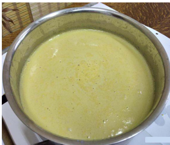
Рисунок 2 – При плавлении кусков воска, измельченного на терке для овощей, в воде образуется водо-восковая эмульсия, из которой очень трудно выделить сухой воск
