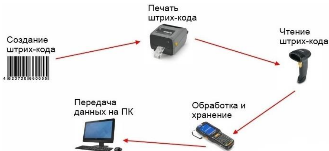
Рисунок 1 – Схема организации инвентаризации с помощью штрих кода
