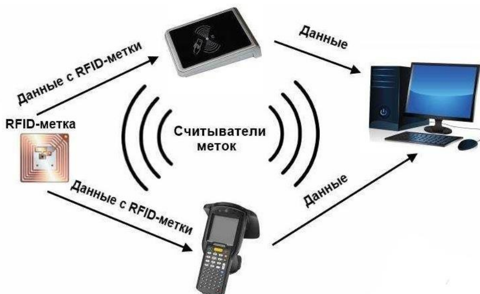
Рисунок 2 – Схема организации процесса инвентаризации с RFID-метками
