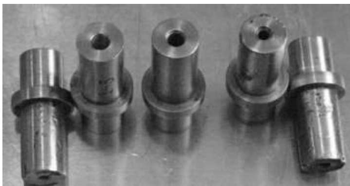
Рисунок 2 – Вид на пример сопловых насадок, применяемых для моделирования кавитации
