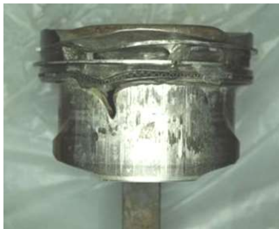
Рисунок 2 – Разрушение деталей из-за отсутствия смазочных материалов при эксплуатации оборудования
