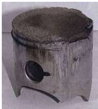
Рисунок 2 – Последствия детонации на примере поршневого ДВС
