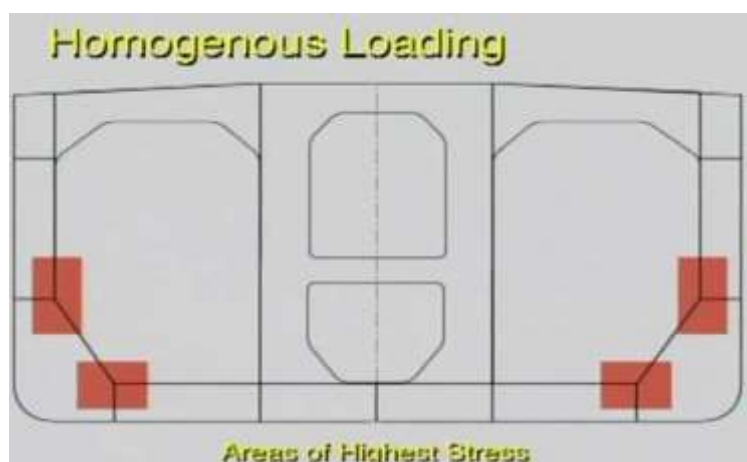
Рисунок 11 – Зоны наибольших нагрузок при однородной загрузке
