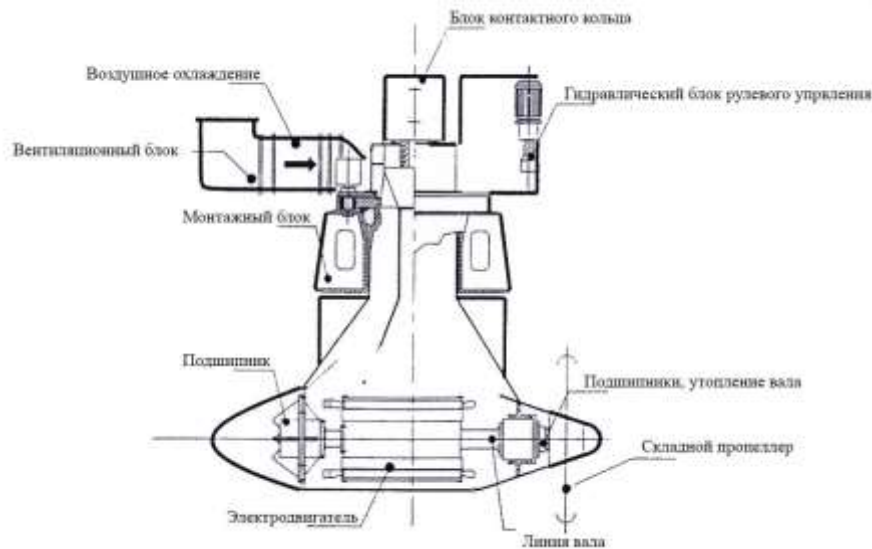
Рисунок 1 – Части двигательной установки капсулы
