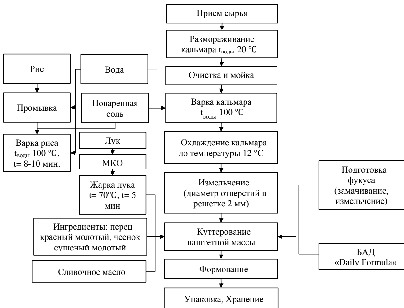
Рисунок 1 – Усовершенствованная технологическая схема паштета из кальмара, обогащенного витаминосодержащим препаратом и минеральными веществами
