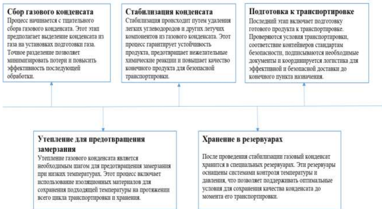
Рисунок 1 – Этапы процесса подготовка газового конденсата к транспортировке
