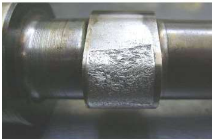
Рисунок 1 – Частичный износ деталей из-за недостаточного количества смазочных материалов
