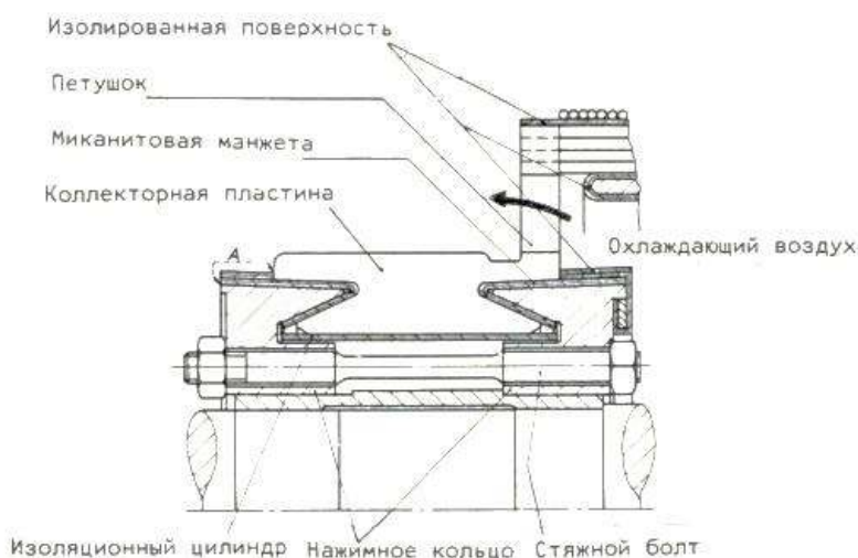
Рисунок 3 – Коллектор с открытыми петушками
