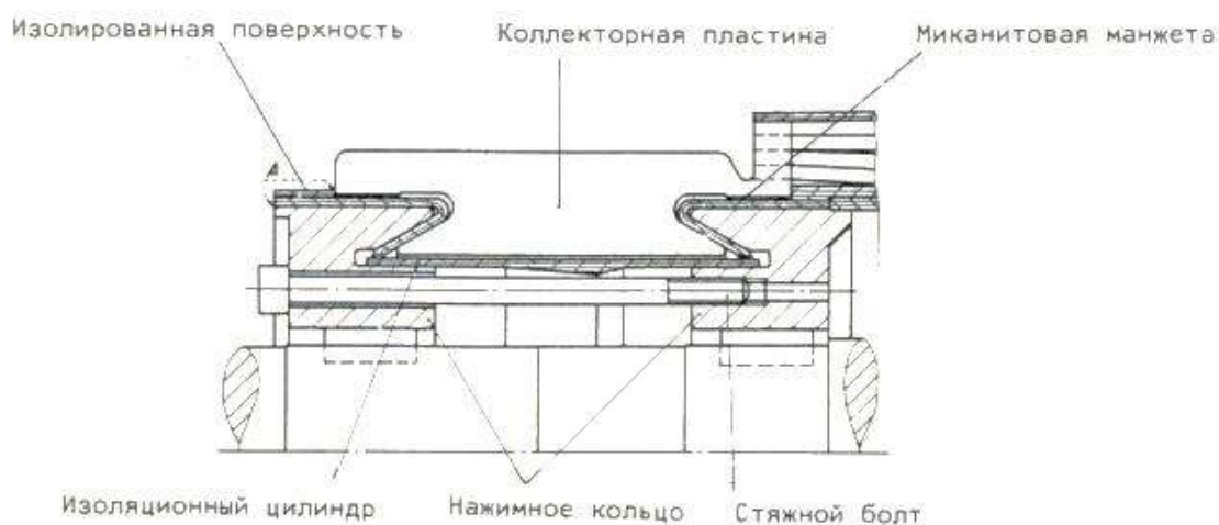
Рисунок 2 – Пример конструкции коллектора
