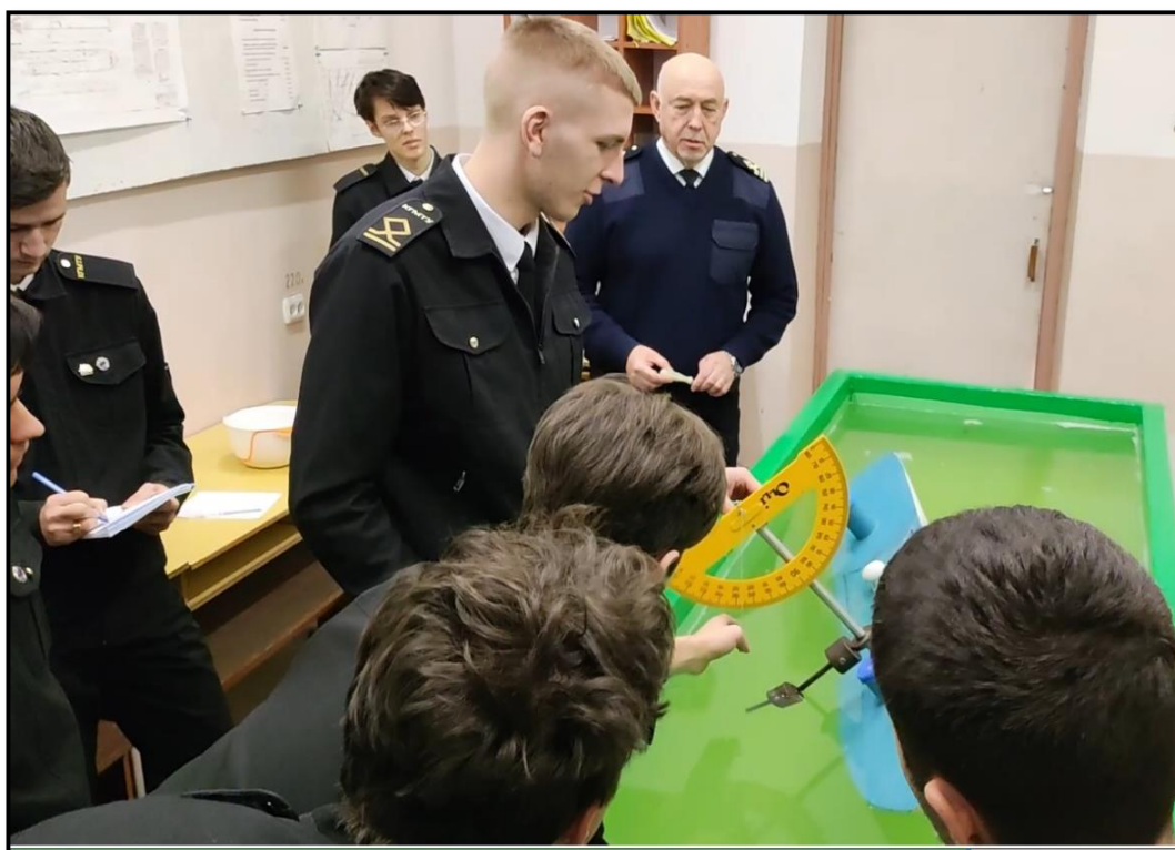
Рисунок 2 – Определение критических углов крена при построении диаграммы статической остойчивости модели
