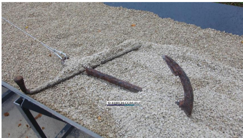
Рисунок 3 – Положение адмиралтейского якоря в грунте
