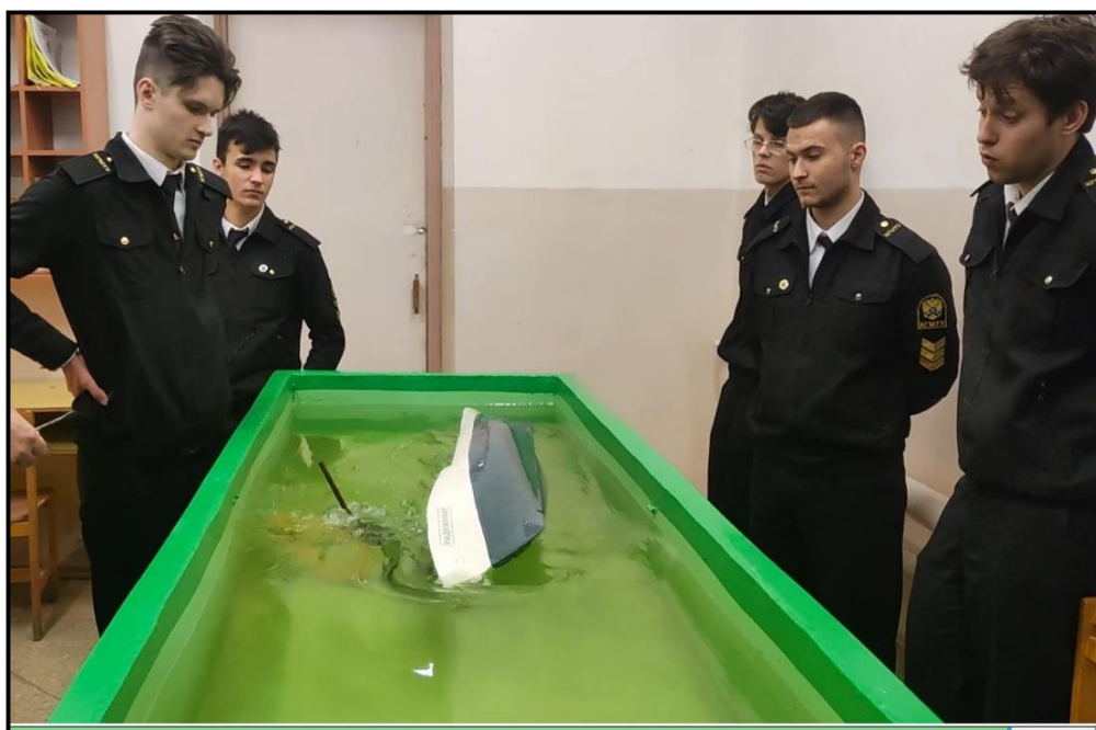
Рисунок 1 – Демонстрация опрокидывания судна в следствии потери устойчивости
