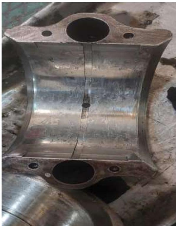
Рисунок 3 – Дефектный подшипник
