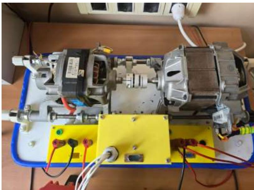
Рисунок 4 – Электропривод лабораторного стенда
