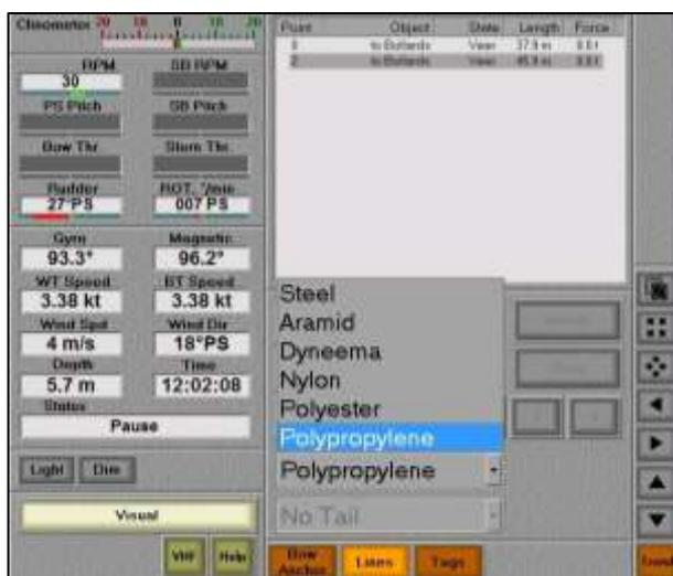
Рисунок 3 – панель управления швартовыми операциями
