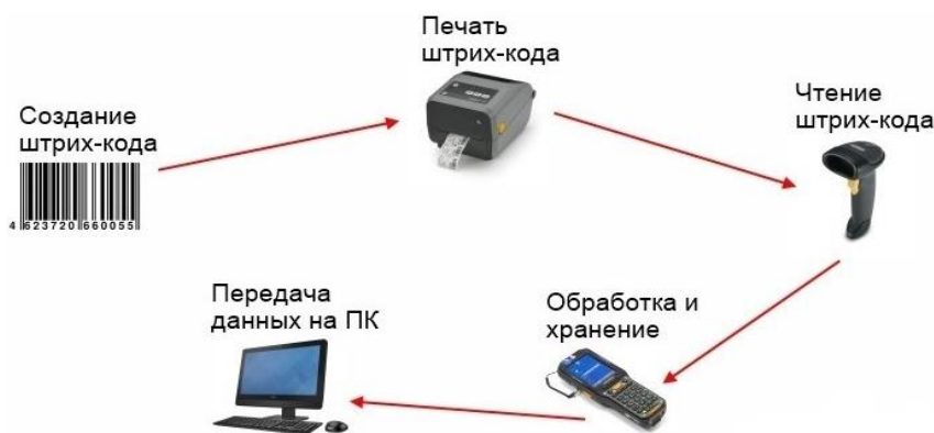
Рисунок 2 – Схема организации инвентаризации с помощью штрих кода
