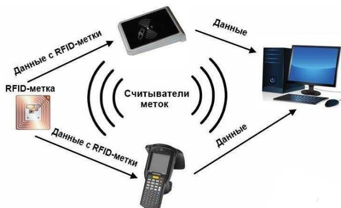
Рисунок 3 – Схема организации процесса инвентаризации с RFID-метками
