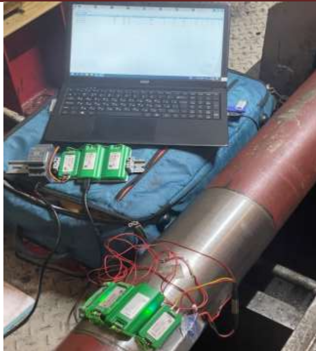
Рисунок 2– Позиционирование датчиков на валопроводе
