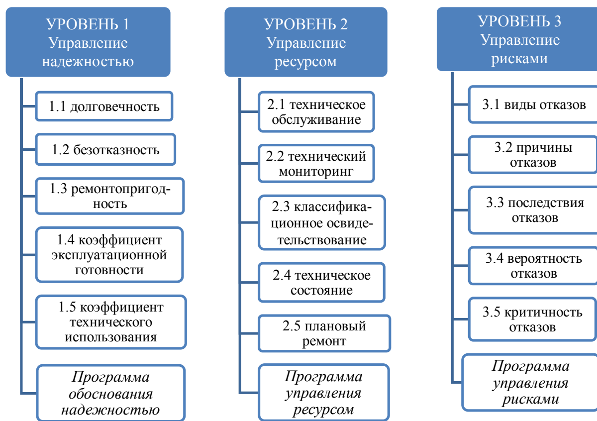
Рисунок 1 – Структурная схема многоуровневой системы обеспечения надежности судовых механических систем на этапах жизненного цикла
