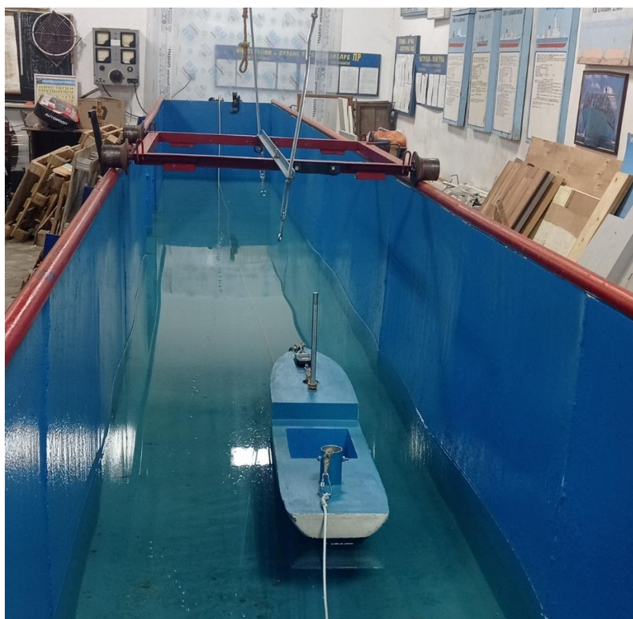
Рисунок 3 – Опытный бассейн с транспортировочной тележкой
