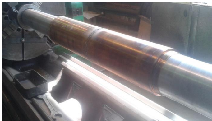
Рисунок 2 – Общий вид облицовки гребного вала
