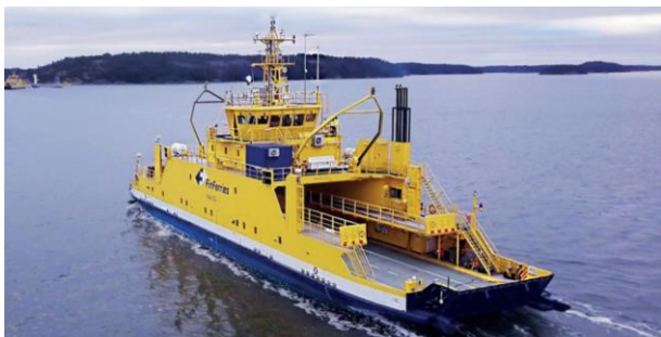
Рисунок 3 – Автономный паром Falco
