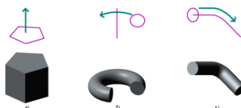
Рисунок 2 - Образование объемных элементов: а) призмы, б) тора, в) кинематического элемента. Плоская фигура, на основе которой образуется тело, называется эскизом, а формообразующее перемещение эскиза — операцией.
