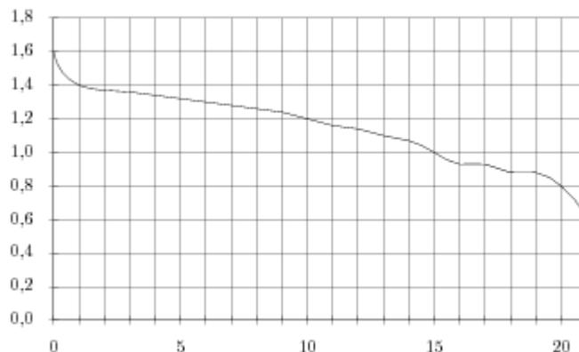
Определите по рисунку, на сколько вольт упадет напряжение за 15 часов работы фонарика.
